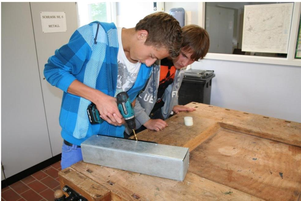
Abbildung 17: Ein Schüler bohrt ein Loch für die Achsaufnahme
