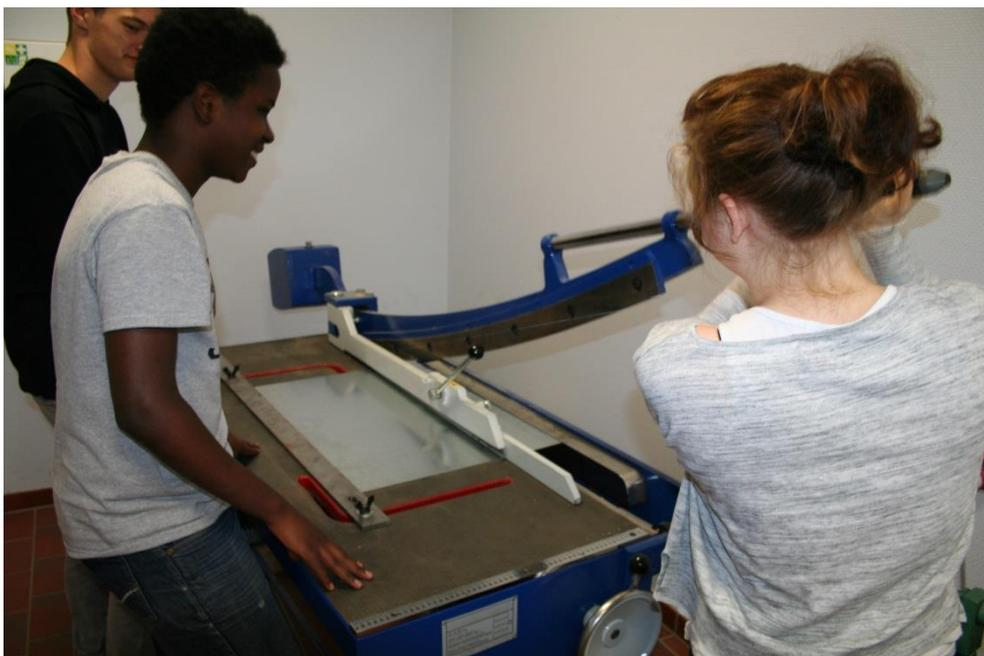
Abbildung 15: Eine Schülerin schneidet Eisenblech für das Trailermodell zu
