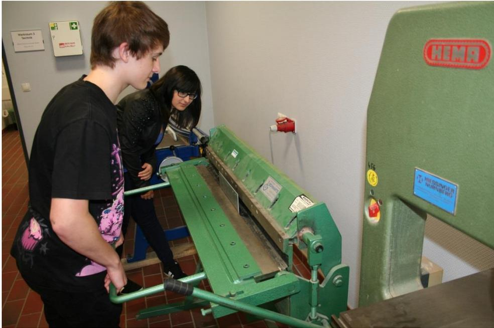
Abbildung 16: Ein Schüler kantet ein Eisenblech für das Trailermodell
